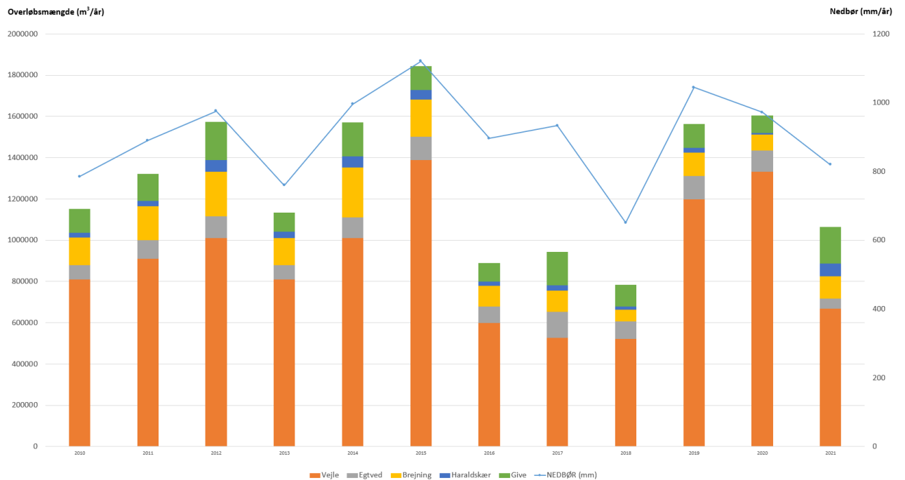
Figur 2: Totalt aflastede vandmængder fra overløb i perioden 2010-2021 og variationen i årsnedbøren
